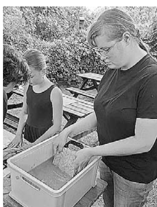
Aus dem vorbereiteten Papierbrei entsteht Schritt für Schritt ein neues Blatt Papier. Pia hebt die Papierpulphe mit dem Schöpfsieb aus dem Wasser, um sie dann auf der Filzplatte in Form zu bringen
