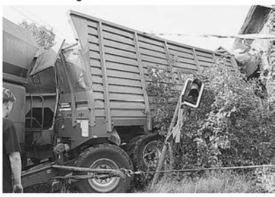
Abziehen des Anhängers von den Wagons mithilfe zweier Seilwinde
