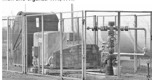
Letzte vorhandene Erdölbohrung FR 33 (Salzwasserschluckbohrung)
