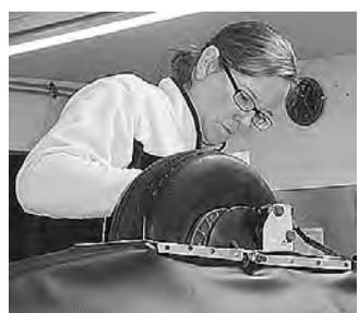
Eine neue Schutzmanschette wird von Heike montiert.
