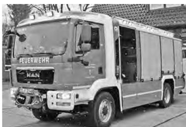
Auf einem MAN TGM 13.290 wurde dieses von Rosenbauer aufgebaute HLF 20 mit Frontseilwinde an die Ortsfeuerwehr Nienhagen übergeben.
