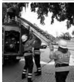
Während der Abschlussprüfung wurde die vierteilige Steckleiter vorgenommen. Hier wird gerade die Steckleiter vom Angriffstrupp vom Fahrzeugdach, mit Hilfe des Maschinisten und des Melders, entnommen.
